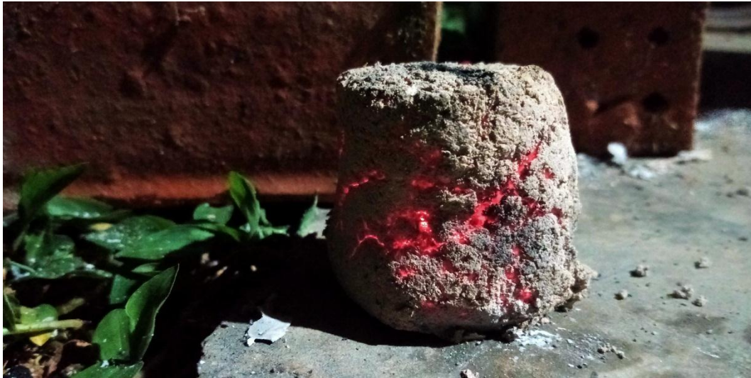
Gambar 14. Proses uji laju pembakaran biobriket.
