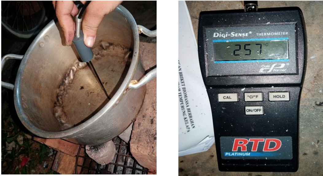
Gambar 15. Uji suhu pembakaran biobriket.
