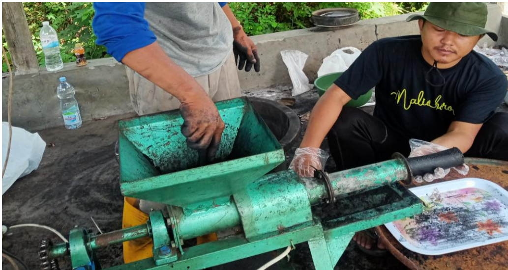
Gambar 8 . Proses pencetakan biobriket.
