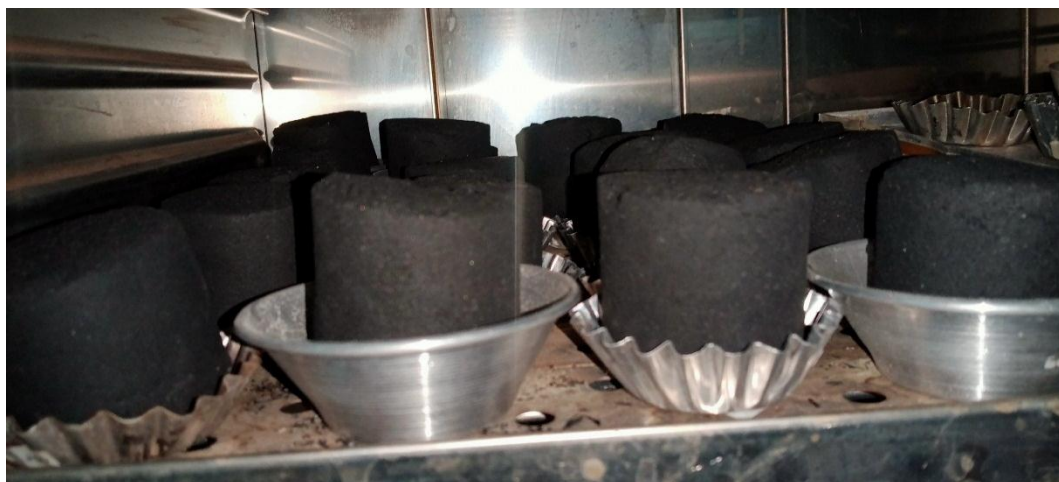
Gambar 11. Pengujian kadar air biobriket menggunakan oven.
