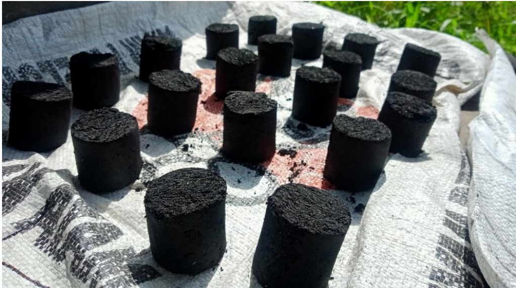
Gambar 9. Proses pengeringan biobriket di bawah sinar matahari.
