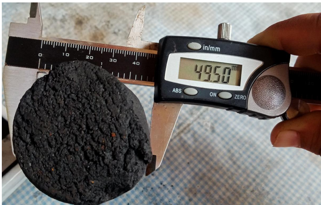
Gambar 10. Pengukuran kerapatan biobriket menggunakan jangka sorong.
