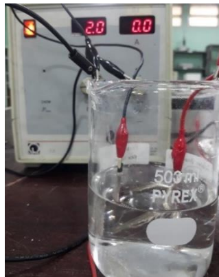
Gambar 3.4. Elektroplating Ag pada Cu
