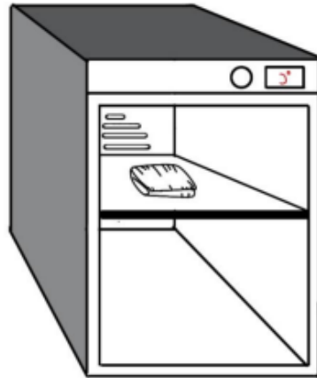
Gambar 5. Skema torefaksi dengan Electric Furnace (EF).
