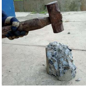
Gambar 3.3. Menghancurkan limbah Beton.
