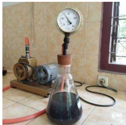
Gambar 3.7. Alat uji kepadatan maksimum.
