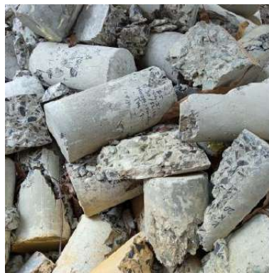
Gambar 3.2. Limbah beton dari Laboratorium Bahan dan Konstruksi.
