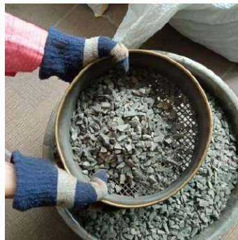
Gambar 3.4. Mengayak Limbah Beton.
