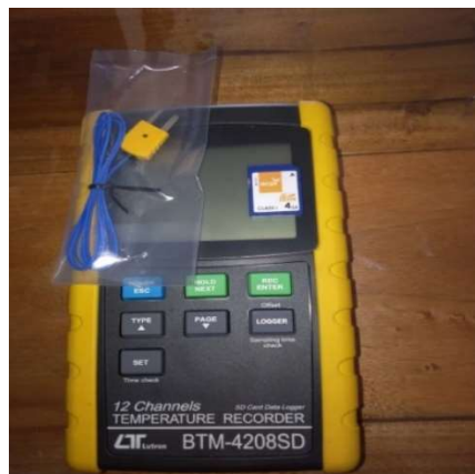
Gambar 3. 2 Thermocouple dan data logger
