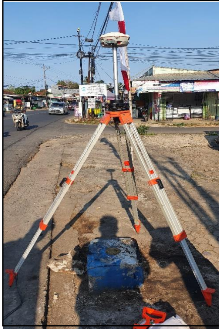
Gambar 9. GNSS dengan acuan titik dasar teknik sebagai base.
