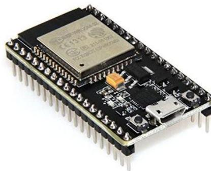
Gambar 2.9 Mikrokontroler ESP32
