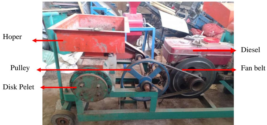
Gambar 2. Mesin Ekstruder
