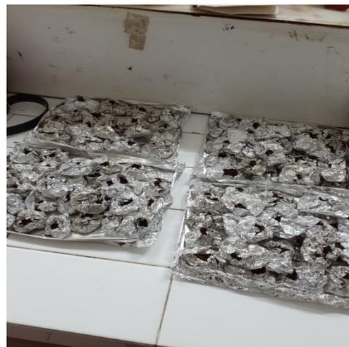
Gambar 5. Tanah Setelah di Oven
