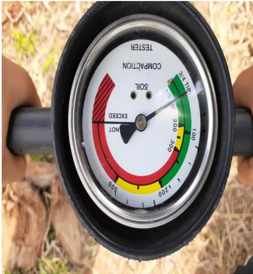
Gambar 2. Penetrometer
