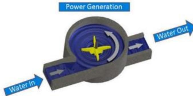
Gambar 2. 3 Skema pembangkit listrik menggunakan turbin vortex (Franz, 2002)
