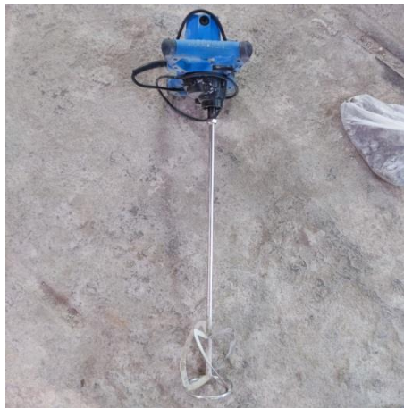
Gambar 3.10 Mesin pengaduk mortar.
