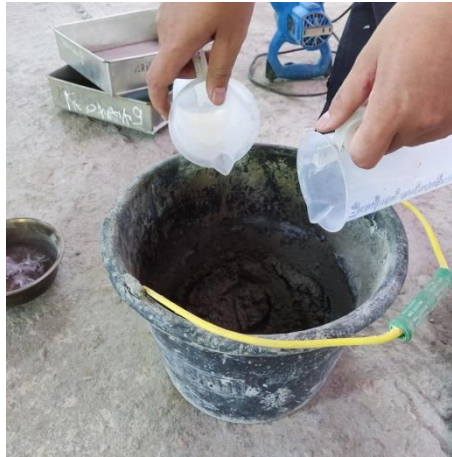
Gambar 3.20 Menambahkan serat polypropylene , air dan superplasticizer
