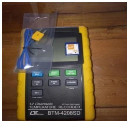
Gambar 3.3 *Data logger* dan termokopel
