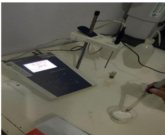
Gambar 4. Proses pengamatan uji pH Sumber : Dokumen pribadi
