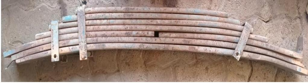
Gambar 33 Baja pegas daun kondisi bekas ( $t=16$  mm)
