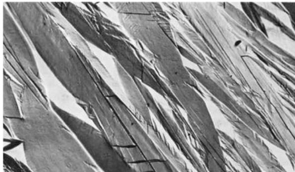
Gambar 13 Plate martensite terbentuk dalam kristal tunggal austenitik dari paduan Fe-33.5Ni dengan pendinginan hingga 196°C. Pelat hanya terlihat karena relief permukaan yang dihasilkan oleh transformasi martensit.
