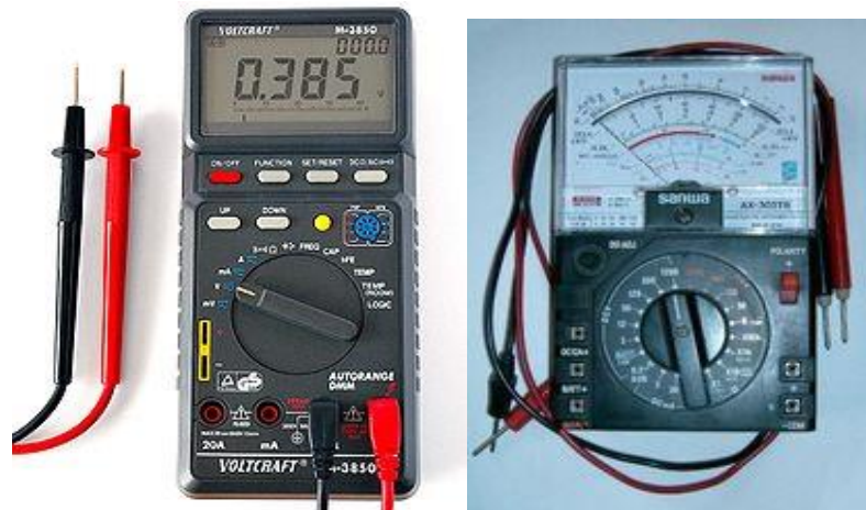
Gambar 6. Multimeter digital dan Multimeter analog Sumber : (Martias, 2017)
