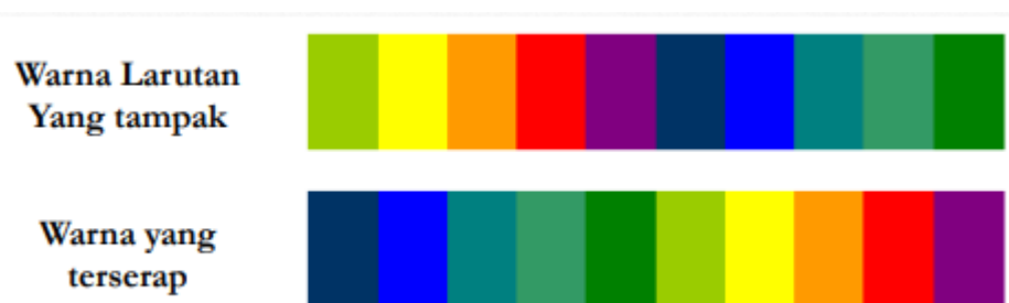
Gambar 2. Warna larutan yang tampak dan warna yang terserap pada Spektrofotometri UV-Vis
