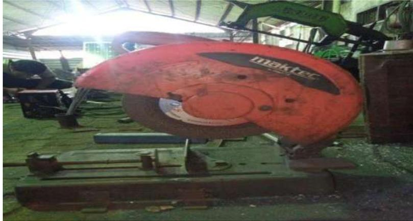
Gambar 3.1 Mesin *cutting* pemotong besi
