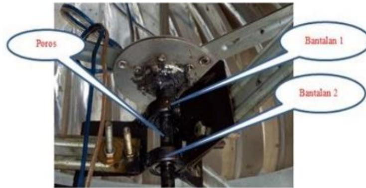
**Gambar 2.1** Bentuk modifikasi poros turbin (Tumembow dan Siwi, 2021)
