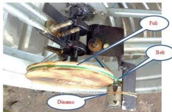
**Gambar 2.2** Posisi *pulley*, dinamo dan sabuk (Tumembow dan Siwi, 2021)
