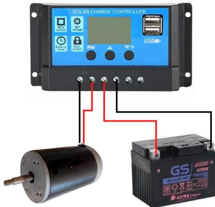
**Gambar 3.3** Skema instalasi kabel pada penelitian
