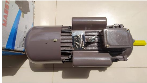
Gambar 2.1 Dinamo Listrik 1 Hp
