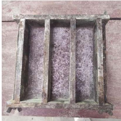
Gambar 13. Cetakan Benda Uji
