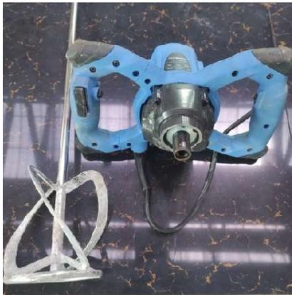
Gambar 12. Mesin Pengaduk Mortar (*Mortar Mixer*).
