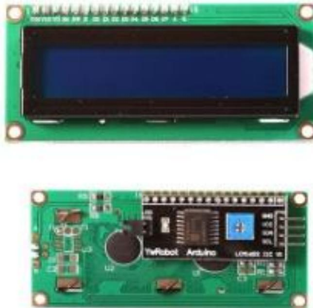
Gambar 11. LCD 16x2 dengan I2C
