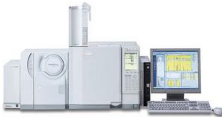
Gambar 8. Alat GC-MS Shimidzu QP 2010 SE (Dokumen Laboratorium instrumentasi Laboratorium Terpadu Universitas Islam Indonesia Yogyakarta, 2022).
