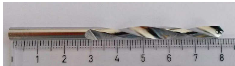
Gambar 3.3. Jenis mata bor tipe pendinginan tertutup (Bruketa, et al., 2019)
