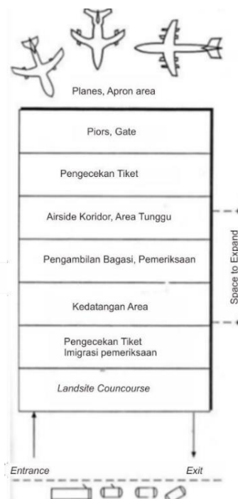
Gambar 2.37 Skema Sirkulasi pada Terminal Penumpang Udara Sumber: The Modern Airport Terminal . Brian Edwards
