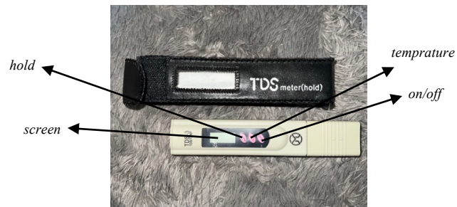
Gambar 13. Alat ukur TDS Meter (Dokumentasi Pribadi).
