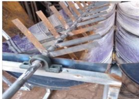
Gambar 15. Pemasangan poros baling-baling
