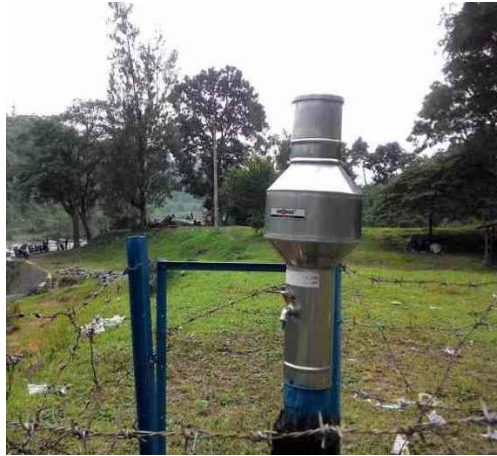
Gambar 2.2 Alat Pengukur Curah Hujan Sumber: masfikir.com
