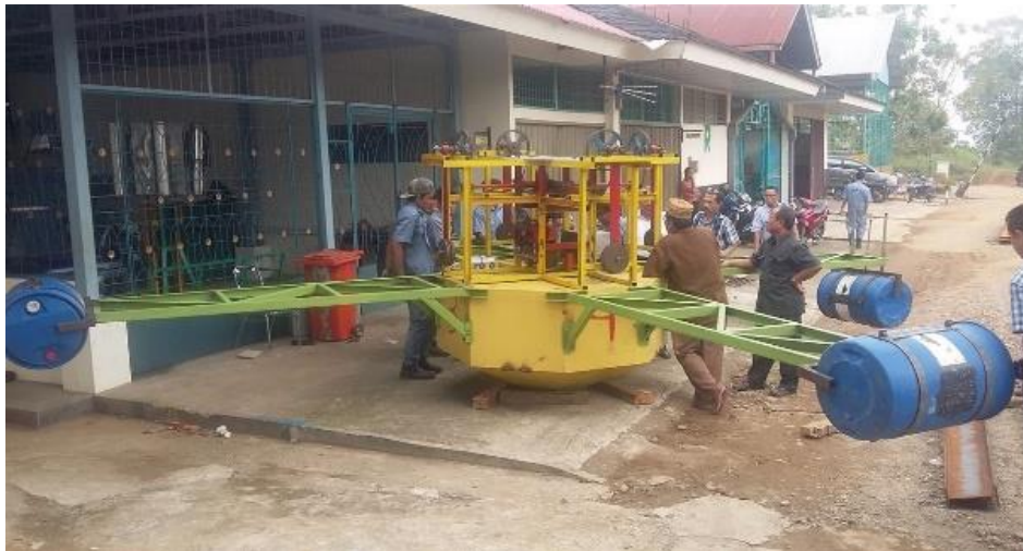
Gambar 2.3 Ponton lengkap saat akan diuji coba (Zamri dkk.,2015).
