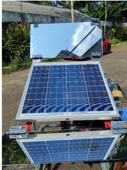
Gambar 3.8 Desain solar tracker panel surya dengan penambahan reflector
