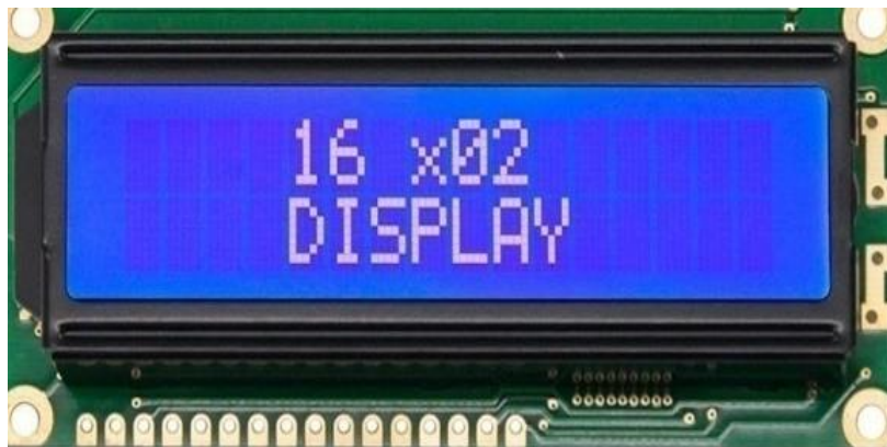
Gambar 2.7. LCD 16x2 (Septiana dkk., 2019)
