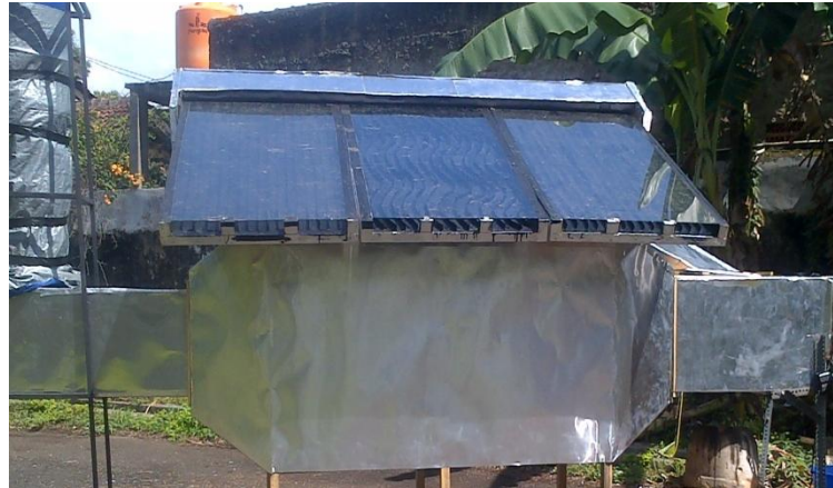
Gambar 21. Kolektor surya pada alat pengering.
