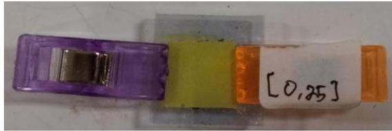
**Gambar 7.** Struktur *sandwich* rangkaian DSSC
