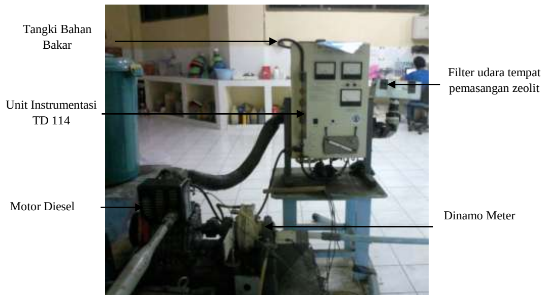
Gambar 8. Rangkaian alat uji dan Unit instrumentasi
