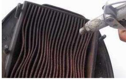
Gambar 5. Filter Udara *Dry Elemen*
