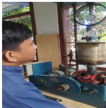
Gambar 3.9 Pengujian CBR
