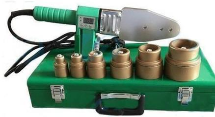
**Gambar 3. 6** Mesin las pipa PPR
