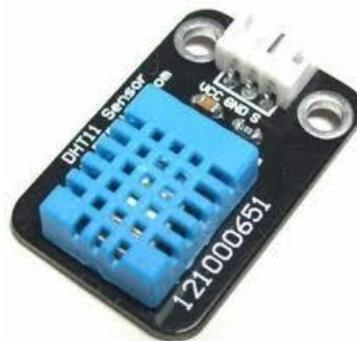
Gambar 19. Sensor suhu dan kelembaban DHT 11
