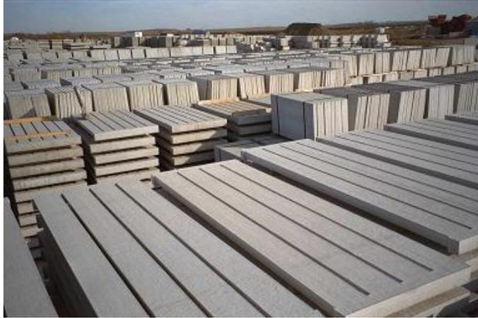
Gambar 4. Pelat panel beton ringan/ *precast*
