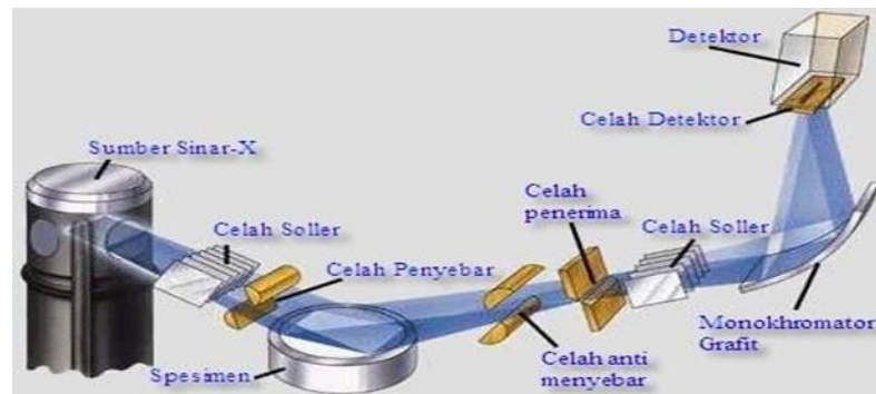
Gambar 2.9 Prinsip kerja XRD (Warren, 1969).
