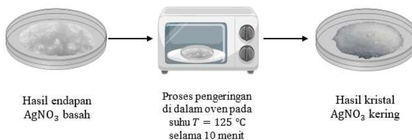
Gambar 3.3 Skema proses kristalisasi \text{AgNO}_3 .
