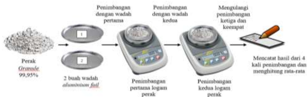
Gambar 3.1 Skema preparasi logam perak
