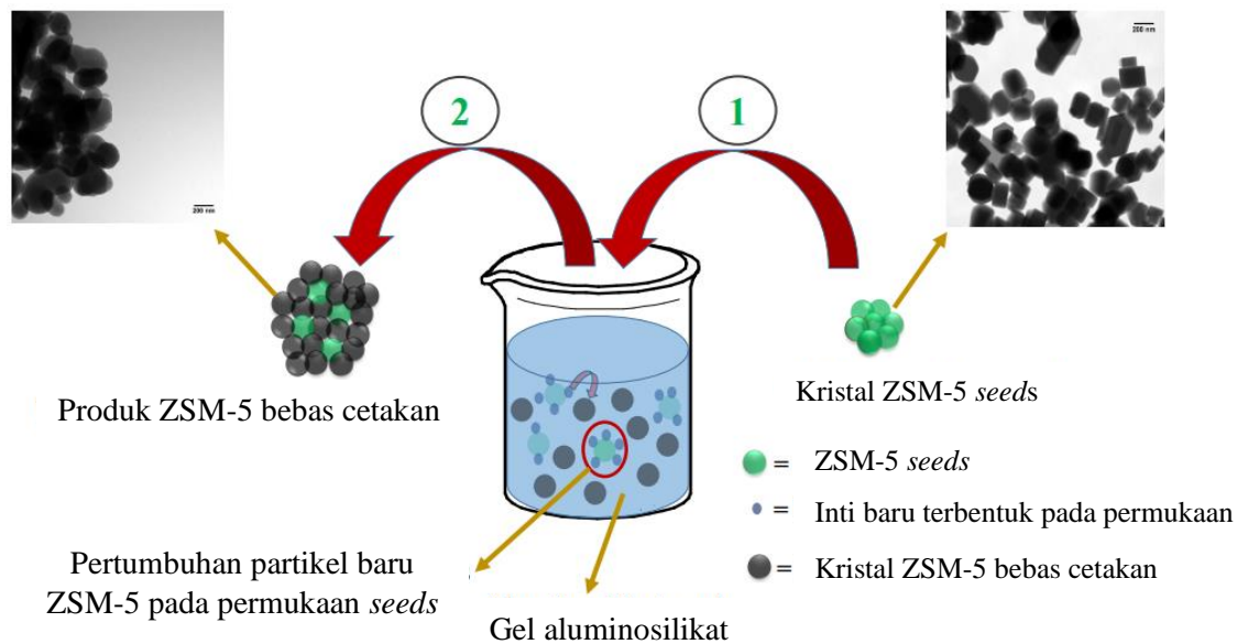
Gambar 9. Skema sintesis ZSM-5 tanpa cetakan organik menggunakan metode seed-assisted (Nada and Larsen, 2016).
