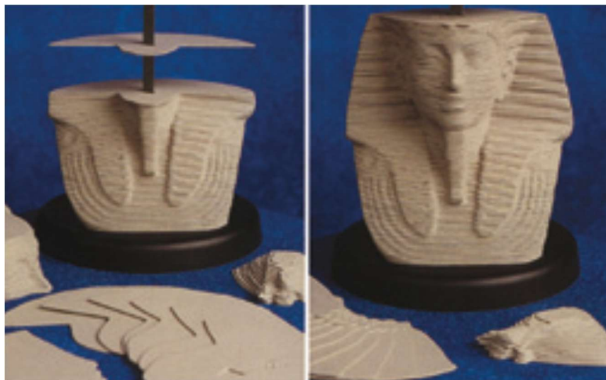
Gambar 2. 10 Prinsip dari layer manufacturing . Lapisan berkontur (kiri), Objek 3D yang dibuat dari lapisan staggered (kanan).
