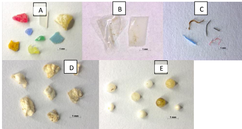
Gambar 3. Bentuk mikroplastik yang teramati : A. Fragmen; B. Film; C. Filamen; D. Foam; E. Pellets. (Sumber: Virsek et al. , 2016)
