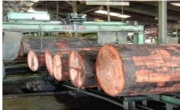
Gambar 5. Pembersihan Ulang Log Kayu (Sumber: Kaila, 2021c)
