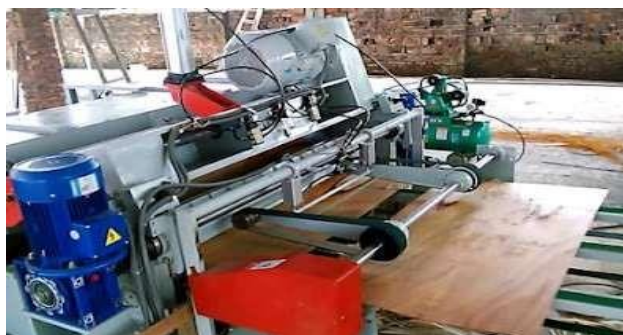
Gambar 7. Pengupasan dengan Rotary Cutting (Sumber: Kaila, 2021)
