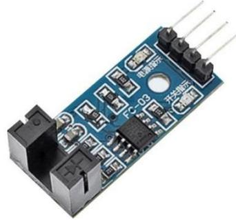
Gambar 2.18 Modul Sensor Kecepatan LM393
