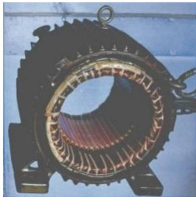
Gambar 2.1 Bagian Stator Motor Induksi
