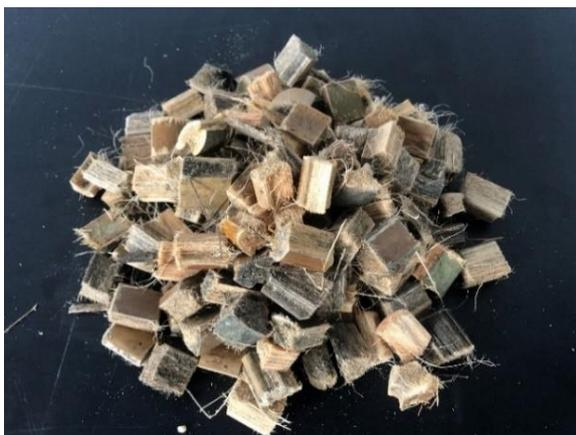
Gambar 3.3 Sampel mentah pelepah sawit (*elaeis guineensis jacq.*).
