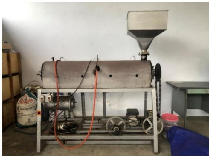
Gambar 3.1 Reaktor torefaksi kontinu tipe tubular dengan sistem pemanas *Oil Jacket* dari LPG.
