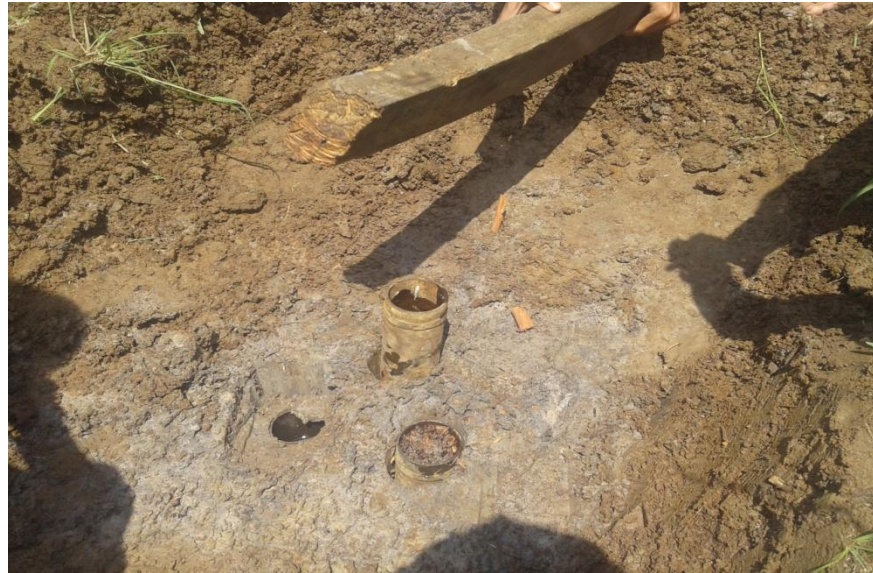
Gambar 3.2 Pengambilan sampel undisturb
