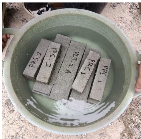
Gambar 32. Perawatan benda uji ( curing ).
