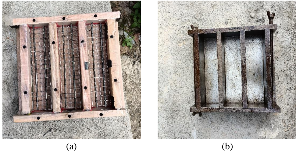
Gambar 11. Cetakan benda uji (a) plat ferosemen, (b) mortar ferosemen.
