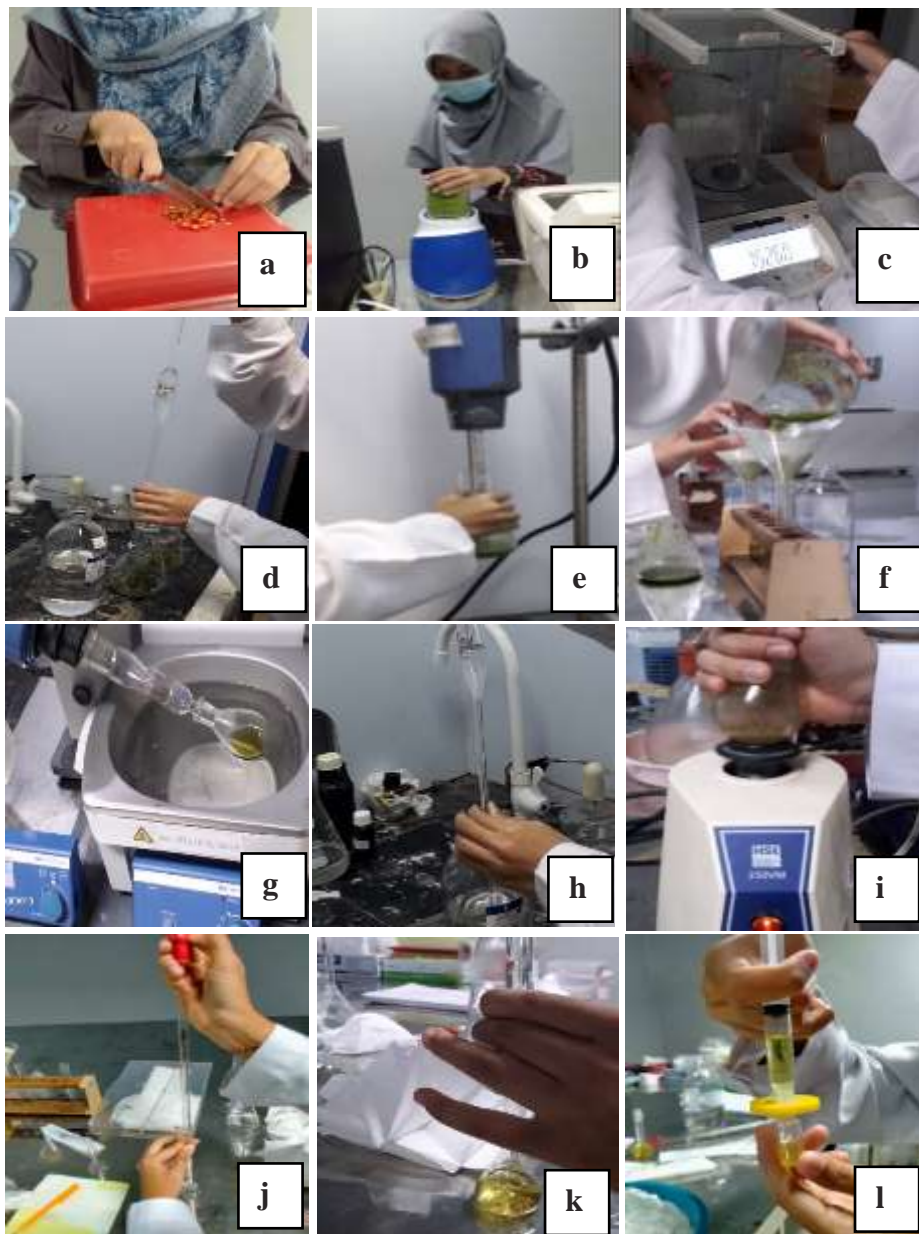
Gambar 6. Preparasi sampel kacang panjang dan cabai merah : (a) pemotongan sampel cabai merah dan kacang panjang; (b) penghalusan sampel menggunakan blender; (c) penimbangan sampel cabai merah dan kacang panjang; (d) penambahan etil asetat kepada sampel; (e) larutan sampel dihomogenkan menggunakan ultra turax; (f) larutan sampel disaring menggunakan saringan yang telah dilapisi Na-sulfat anhidrat sebanyak 3 kali ulangan; (g) larutan sampel dievaporasi hingga kering; (h) penambahan asetonitril : air (60 : 40); (i) larutan dihomogenkan menggunakan vortex; (j) larutan dipipet dan dimasukkan ke labu ukur 1 mL (k) penambahan asetonitril : air (60 : 40) ke larutan (l) larutan sampel disaring menggunakan kertas saring 0,2 µm (Foto : Fitriyani).
