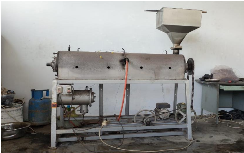
Gambar 3.1 Reaktor torefaksi kontinu tipe tubular dengan sistem pemanas oil jacket dari LPG.
